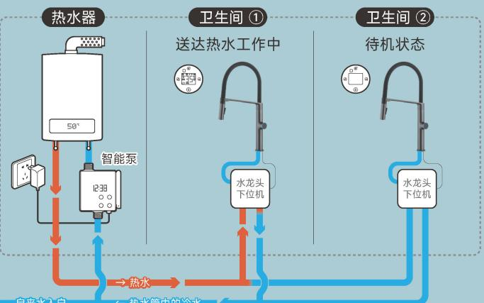
当用户需要使用热水时，不用预先排放热水管里的冷水，打开水龙头秒出热水。
